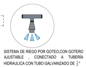
SISTEMA DE RIEGO POR GOTEO, CON GOTERO AJUSTABLE, CONECTADO A TUBERÍA HIDRAULICA CON TUBO GALVANIZADO DE 1/2"
