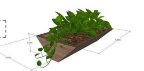
DETALLE DE CONTENEDOR DE SUSTRATO PARA VEGETACIÓN, A BASE DE MADERA DE PINO, CON ACABADO TRANSPARENTE Y REPELENTE AL AGUA. SOPORTE A BASE DE HERRERÍA SOLDADA Y ANCLADA A MURO DE TABIQUE ROJO RECOSIDO.
