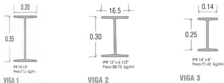
Ilustración 77 Detalles de perfiles de vigas
