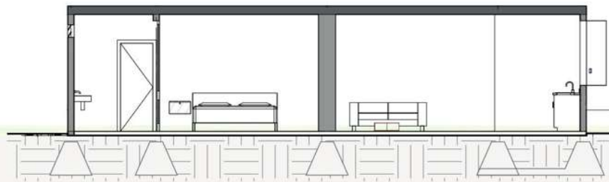
SECCIÓN LONGITUDINAL CABAÑA PAREJA
