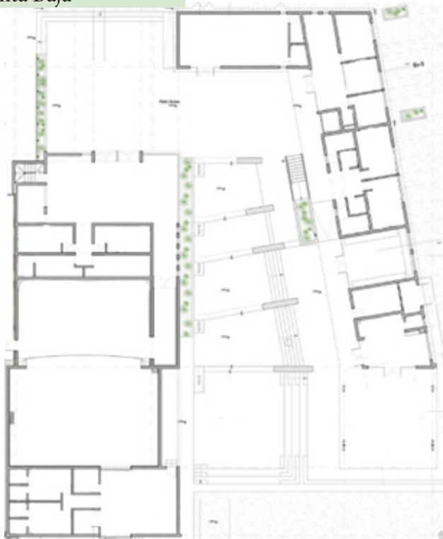
Estructura de muros de carga, y volado soportado con acero
