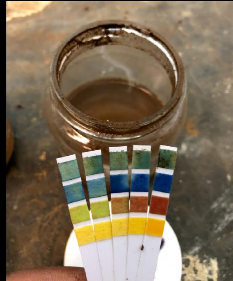
INCREMENTO DE pH DE MUESTRA 1 CON 2% DE CAL A MUESTRA 5 CON 6% DE CAL.
