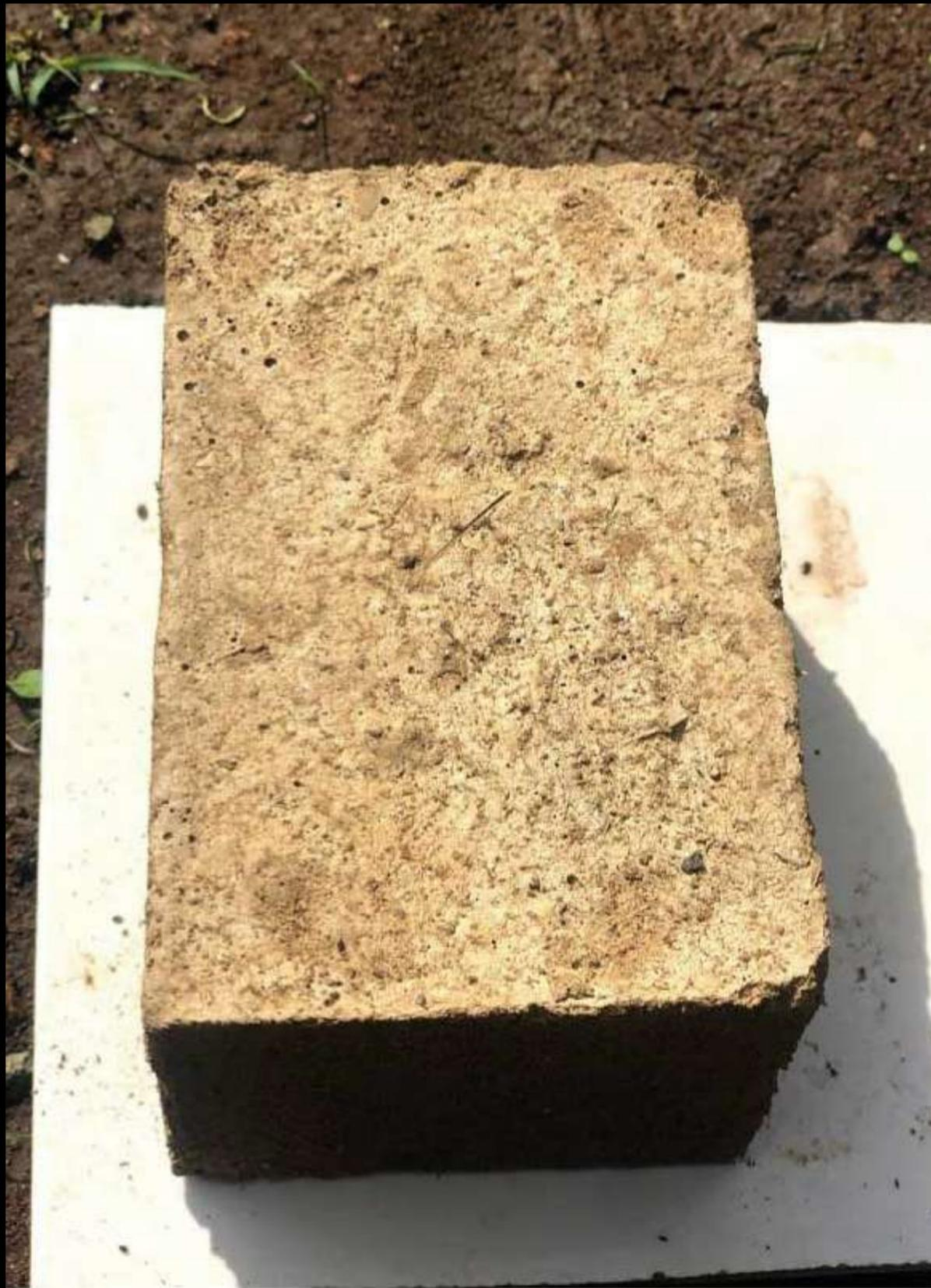
El Bloque BTH Liso de arcilla es una pieza sólida de forma prismática y de caras lisas, que se produce de manera manual sobre moldes de madera recubiertos de aceite vibrados, que garantiza una resistencia competente, de absorción baja.
