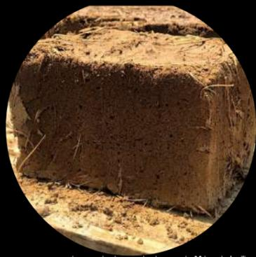
proceso de secado de mezcla despues de 22 hrs al aire libre
