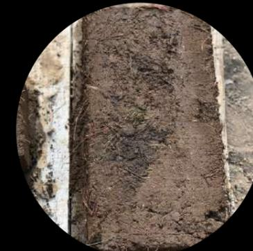
proceso de secado de mezcla después de 3 hrs al aire libre
