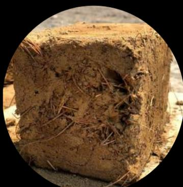
proceso de secado de mezcla despues de 24 hrs al aire libre
