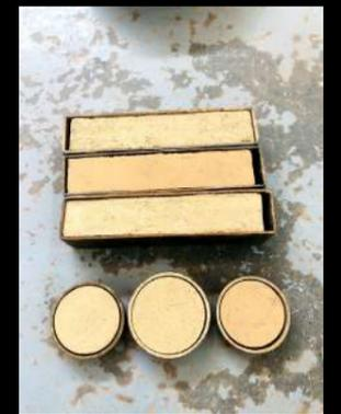
MUESTRAS DE MATERIAL ESTABILIZADO DESPUES DE 48 hrs DE SECAFO EN EL HORNO
