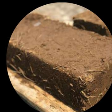
proceso de secado de mezcla después de 22 hrs al aire libre
