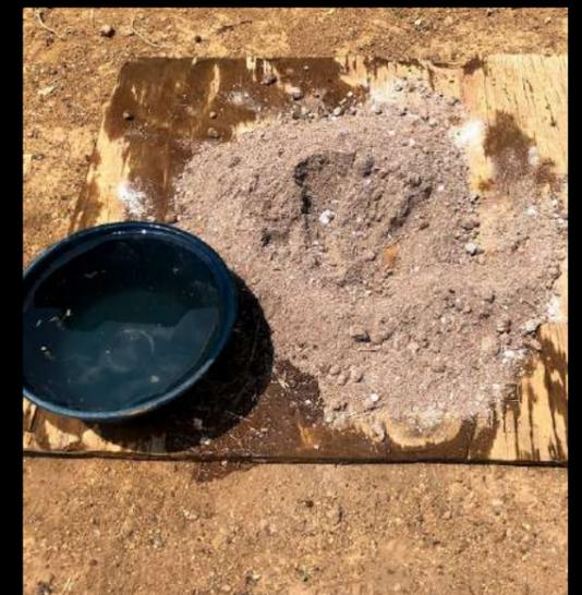
MEZCLA DE ARCILLA CON 1/8 DE HUIMUNO Y 6% DE CAL DE CONSTRUCCION
