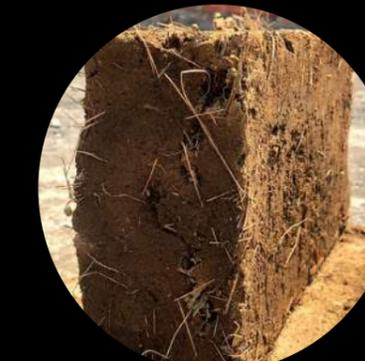
proceso de secado de mezcla después de 24 hrs al aire libre
