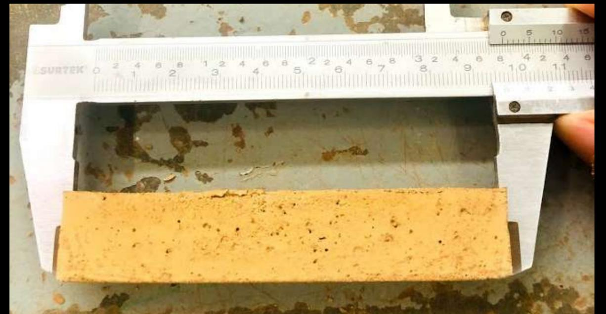
MEDICION DE MUESTRA DE CONTRACCION MATERIAL ESTABILIZADO
