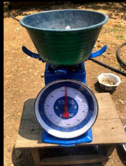
PESO DE 96 gr DE CAL DE CONSTRUCCION EQUIVALENTE AL 6%
