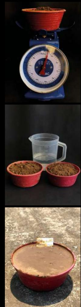
500 gr de tierra en seco y 200 ml de agua para mezclar completamente y revisar la transformación de la masa en mojado.
