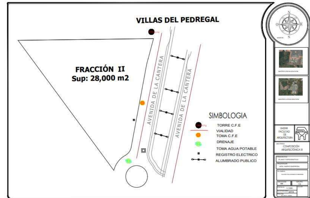
Figura 38. Plano localización de servicios. Fuente: creado por Alicia Villanueva Medina en la aplicación de AutoCAD 2019(19/10/20)
