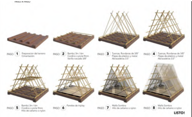
Imagen 5.3: Proceso constructivo del módulo recon bambú.
