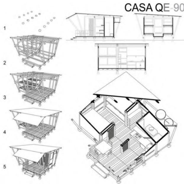
Imagen 6.1: Detalles de la edificación QE-90
