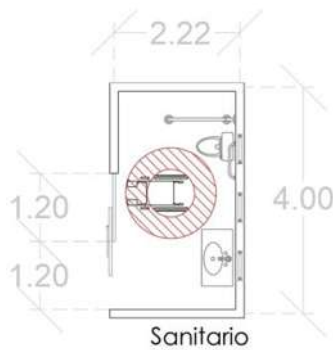
Figura 64. Medidas reglamentarias para sanitario. Fuente: Nayeli Aguilar 28.04.21
