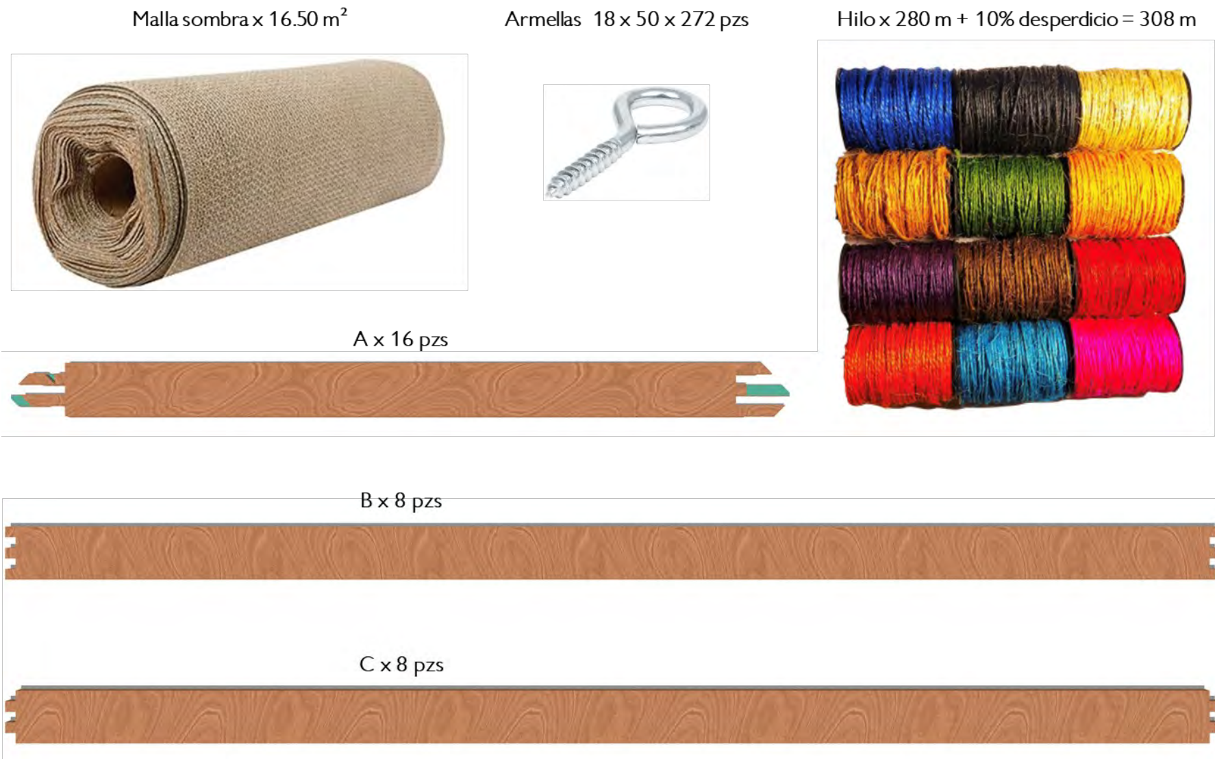
Figura 82. Hernández, A. (2021). Materiales necesarios para la estructura final. [Imagen]. Elaboración propia con imágenes obtenidas de Google y modelados.
