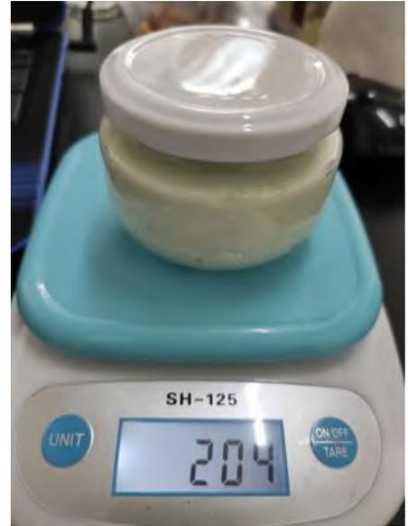
El primer paso es pesar el envase y descontar su peso en la bascula de gramos, el frasco de 100ml, pesa entre 98 y 100gr, mientras el de 50ml pesa entre 8 y 10 gr.
