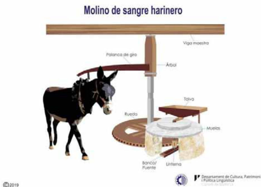
Ilustración 32.- Esquema de molino de sangre harinero. Obtenido de https://web.conselldemallorca.cat/es/-/molins-de-sang
