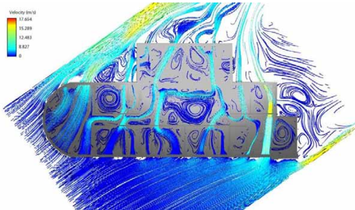
Ilustración 94.- Análisis de flujo de vientos dominantes en cuerpo de criba. Vista en planta. Elaboración del autor.
