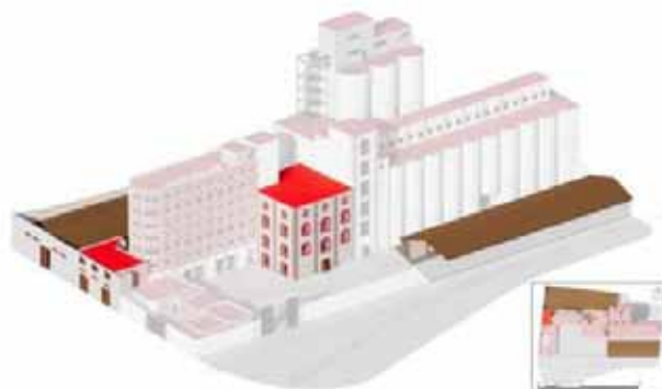
Ilustración 37.- Morfología de una harinera tomando como ejemplo el conjunto fabril "Harinera Michoacana". Elaboración del autor.
