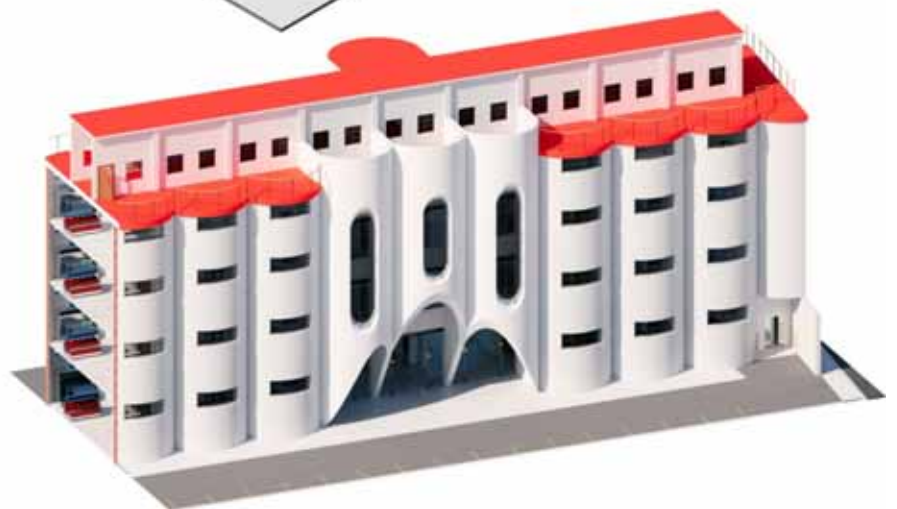
Ilustración 118.- Perforaciones y liberaciones de la batería de silos de 1940 en el conjunto fabril "Harinera Michoacana". Elaboración del autor.
