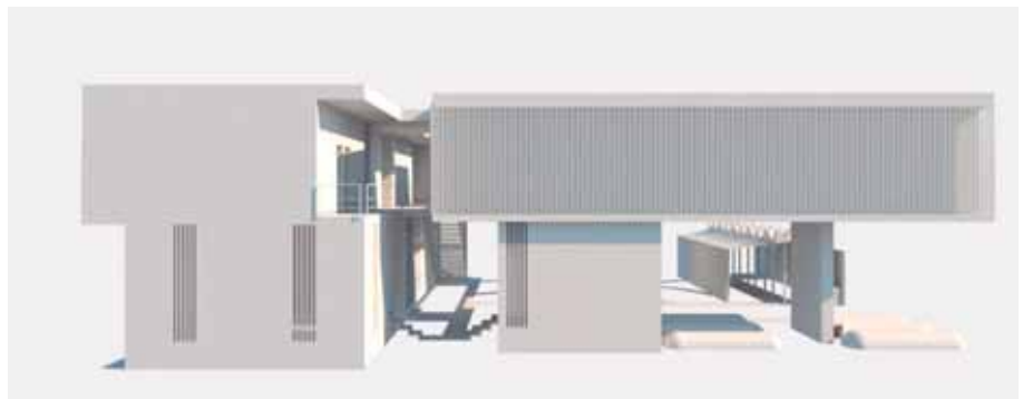
Figura 43. Prueba inicial con celosía de madera y soporte con muro de carga.
