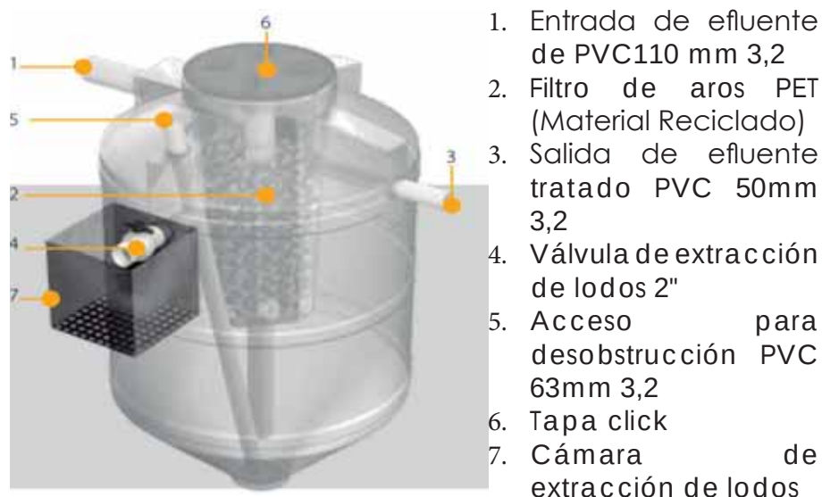
Figura 31. Componentes de biodigestor.
