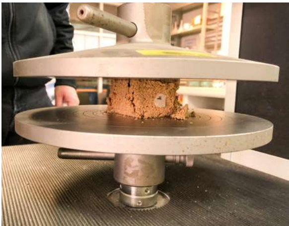
FIG.106 Prueba de compresión (viruta pulido)
