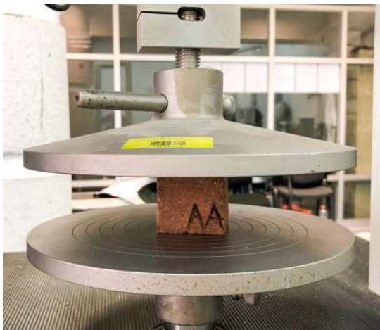
FIG.107 Prueba de compresión (aserrín corte)
