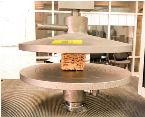
FIG.108 Prueba de compresión (viruta corte)
