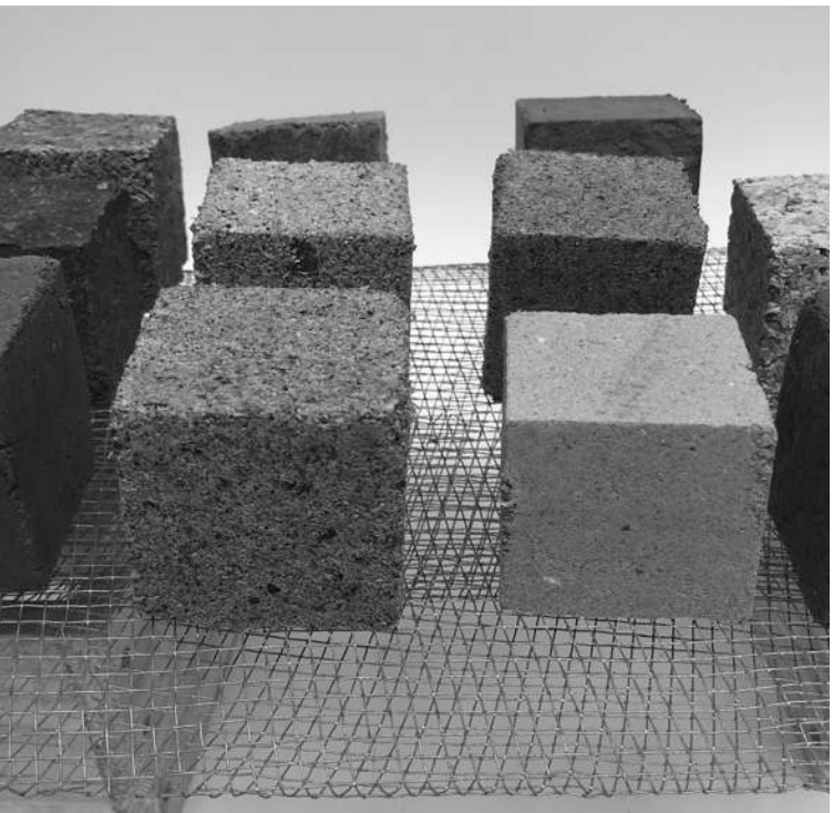
FIG.99 Muestra desmoldadas secadas sobre malla metálica
