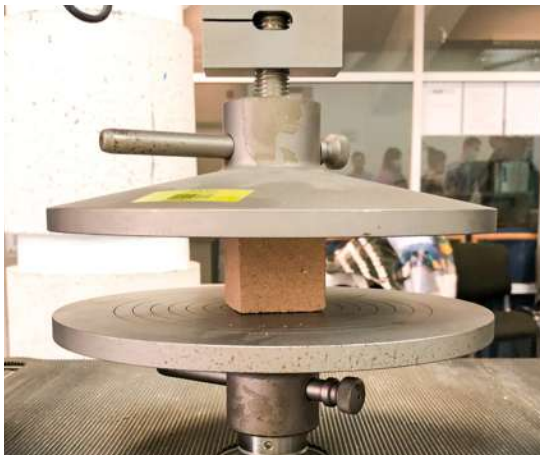
FIG.105 Prueba de compresión (aserrín pulido)
