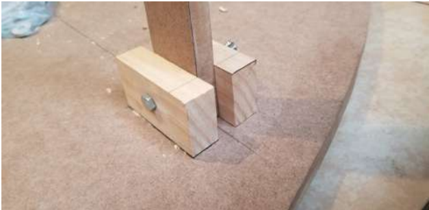
Fig.79 Sistema de anclaje con tornillo 2 1/2”. 3
