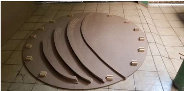
Fig.76 Anclas fijadas en los puntos de anclaje sobre la base.
