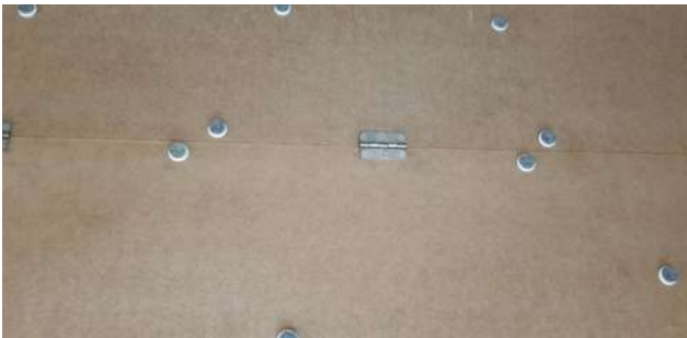
Fig.73 Unión media de la base con bisagras y soporte con regatones
