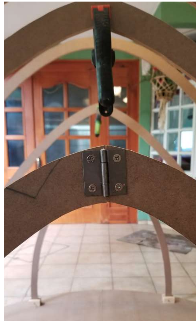
Fig.81 Unión entre perfiles opuestos mediante bisagra.
