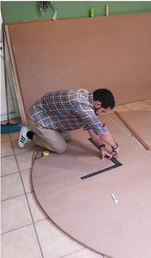
Fig.74 Trazado de marcas de puntos de ancla sobre la base.
