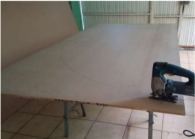
Fig.67 Cortado de la base sobre panel de mdf.
