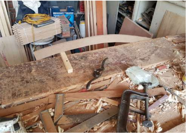
Fig.71 Cepillado de perfiles para pulir imperfecciones.
