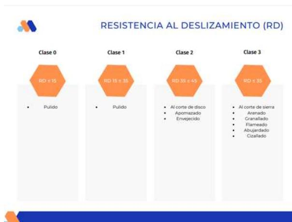
Figura 66. Tabla de resistencia al deslizamiento (Rd). Diseñado por Katia M. Garibay Jacobo.
