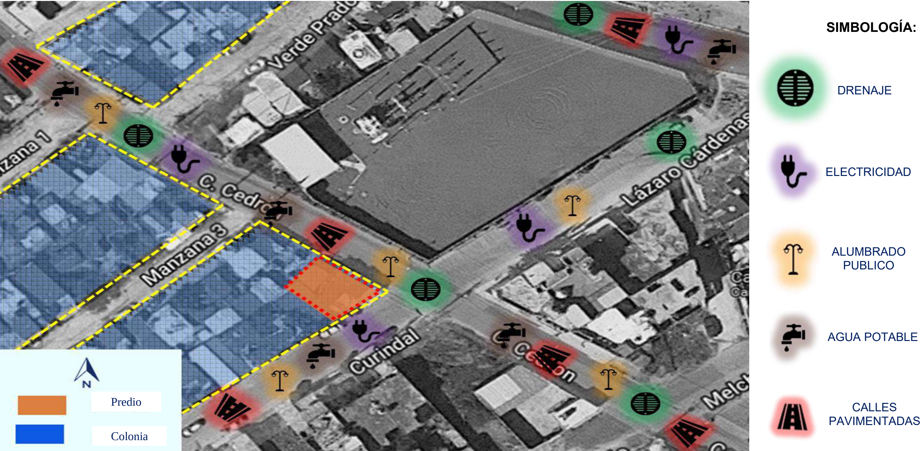
Ilustración 60. Infraestructura con la que cuenta la vivienda a intervenir de la colonia Brisas del Sur. Autor Miguel Ángel Peñaloza Cruz.
