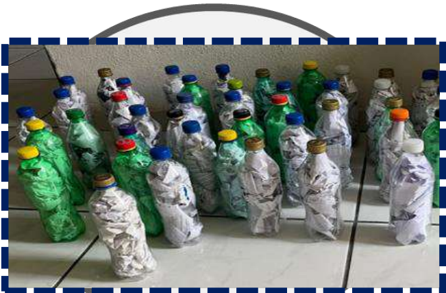
Elaboración de los eco-ladrillos
