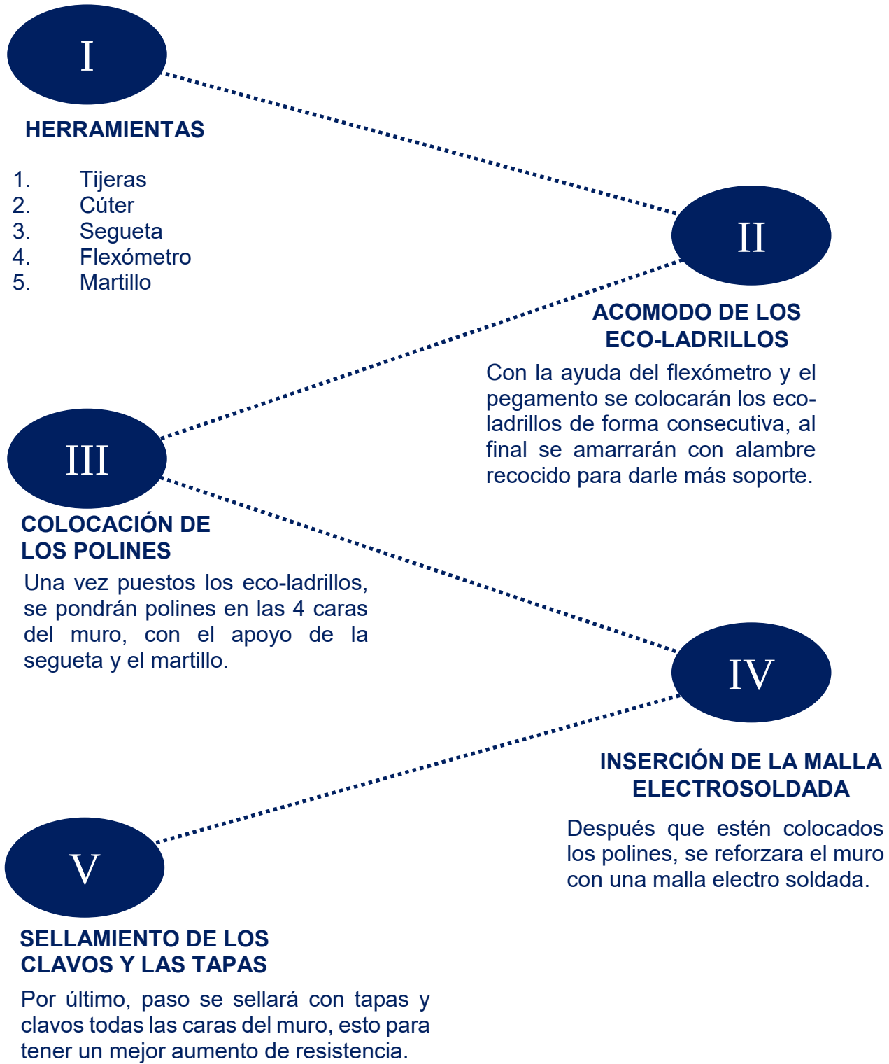
Ilustración 99. Proceso constructivo de la elaboración del módulo. Autor Miguel Ángel Peñaloza Cruz.
