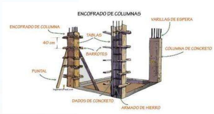
Imagen. 111. Columna de concreto armado
