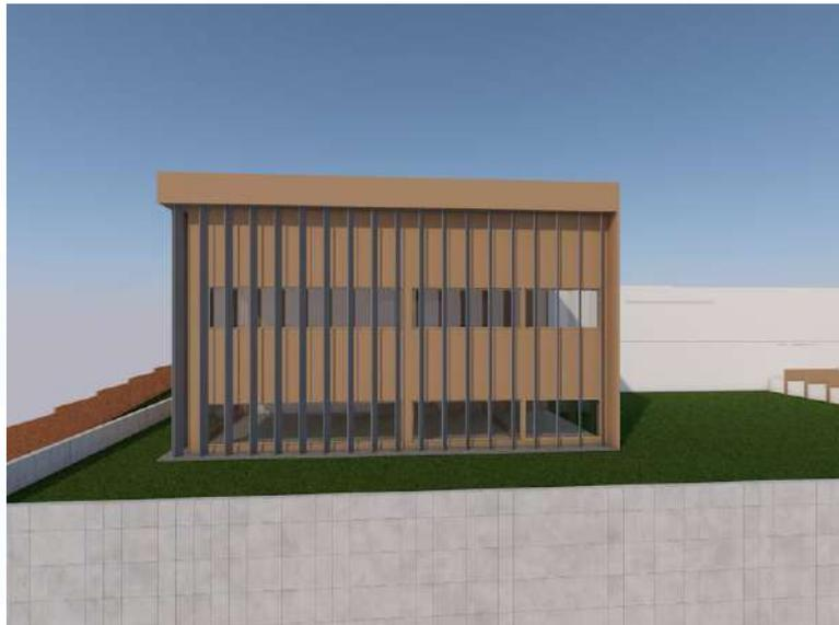
**Imagen. 238.** El parte sol una solución para evitar el excesivo asoleamiento.
