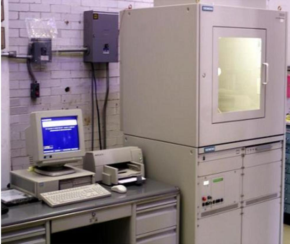
**Figura III.1** Difractómetro SIEMENS D-5000
