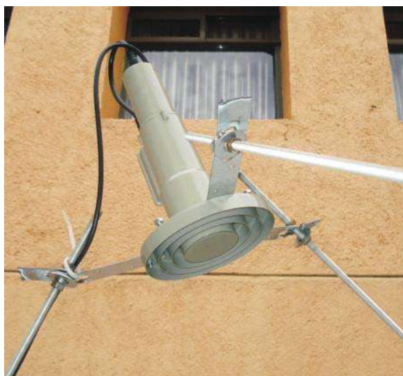
Figura 6.1: Montura del LNB de nuestro radiotelescopio. Esta montura es la parte más primitiva de nuestro arreglo, porque en principio sólo era provicional, aunque nunca se contruyó una nueva versión, en un taller de torno con características para nuestro propósito, ésta claramente se puede mejorar.
