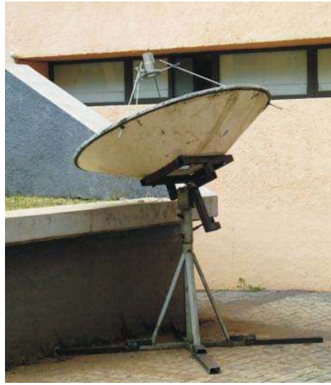
Figura 5.2: Nuestro radiotelescopio de tránsito. Se puede ajustar la elevación del plato para captar astros distintos, pero la base se queda alineada sobre una línea Norte-Sur para captar el astro cuando pase por el meridiano.
