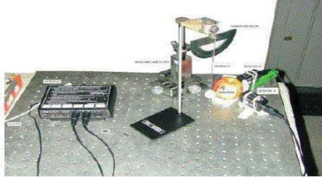
Figura 2.7: Arreglo experimental instrumentado para medir el índice de firmeza de frutos mediante la técnica de impacto acústico.
