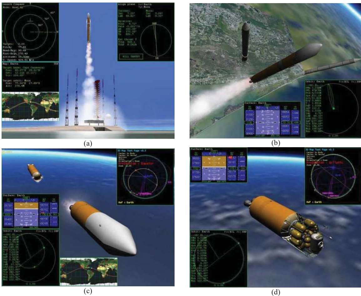
Fig. 4.21. Simulación de lanzamiento. (a) CaLV a T+12s, (b) Expulsión de cohetes auxiliares a T+2m9s, (c) Expulsión fase 2 ignición fase 3 a T+9m35s, (d) Corte de propulsores y puesta en órbita a T+12m35s.
