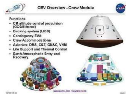
Fig. 4.14. Módulo de reingreso (CEV)
