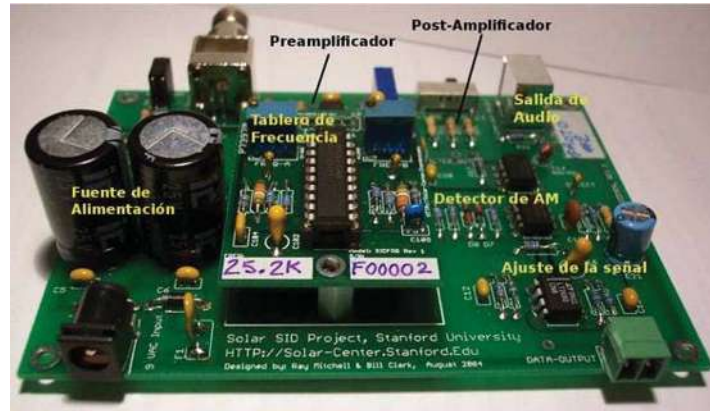
Figura 3.4: Monitor SID. Teoría de operación. Fuente: http://solar-center.stanford.edu/SID/pictures.html .
