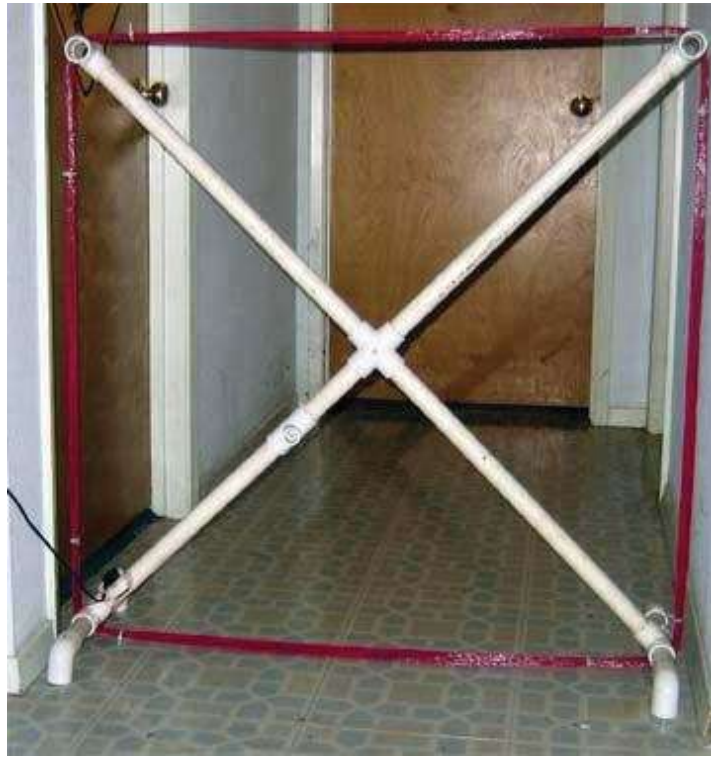
Figura 3.1: Antena utilizada para la recepción de ondas de radio de muy baja frecuencia
