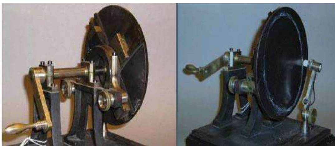
Figura 1.6 Modelo del trasmallo de la colección cinemática de Reuleaux (Foto del profesor D.W. Henderson).
