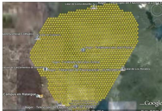
Figura 3.3: Esquema de la distribución de tanques y telescopios en Observatorio P. Auger.
