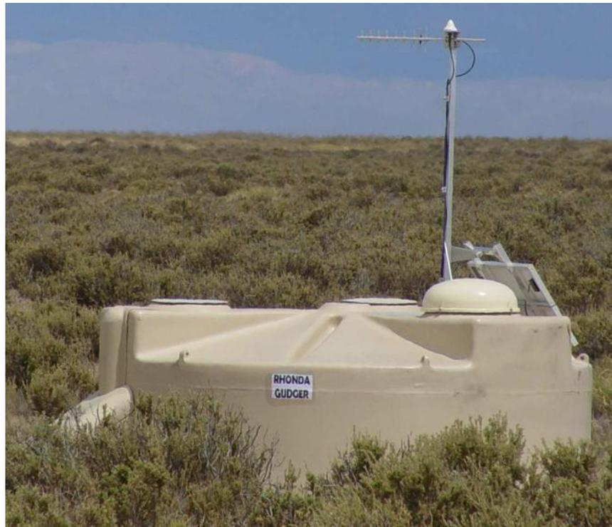
Figura 3.4: Detector de Superficie (Estación) Observatorio P. Auger.
