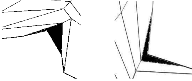
Figura 4.5: Frontera mal condicionada en CRN.
