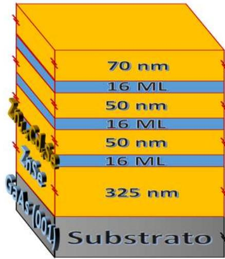
Figura 3.1. Esquema de la muestra con tres pozos cuánticos de  $Zn_{1-x}Cd_xSe$  crecidos por SPBE.
