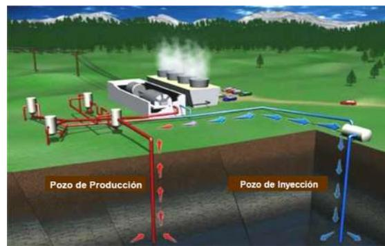
Figura 6.4: Modelo de pozos de producción e inyección
