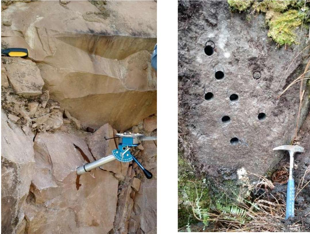
Figura 21. A) Orientación de muestras *in situ* con la Brújula, B) Detalle de la roca donde se obtuvieron las muestras del sitio CB4.
