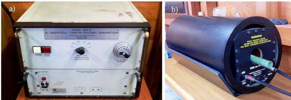
Figura 24. a) Unidad central del desmagnetizador GSD-5, b) Cabina de desmagnetización
