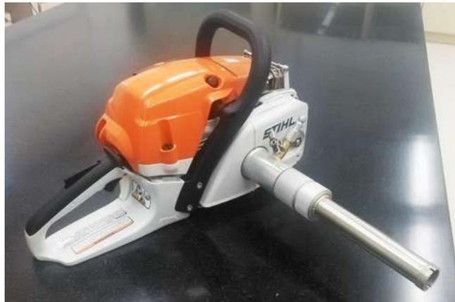
Figura 20. Perforadora de núcleos modelo D261-C marca Stihl.
