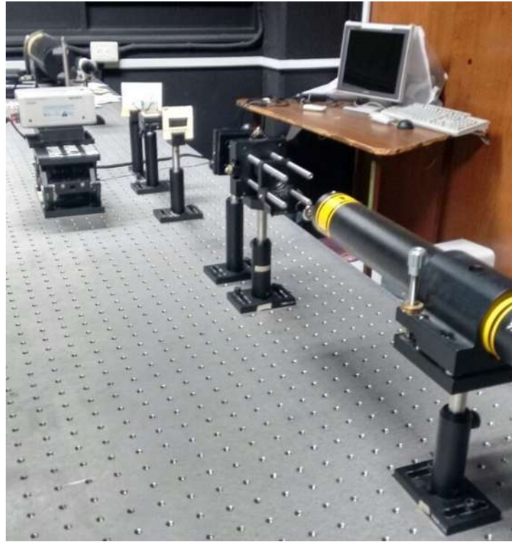
Figura 22. Fotografía del arreglo experimental compuesto por un láser, un colimador, una lente, una rejilla Ronchi (de período \lambda ), un divisor de haz, una cámara CCD y una computadora.
