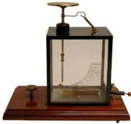
Figura 1.1: En la imagen se muestra un electroscopio similar a los usados a finales del siglo XIX. *Fuente imagen [1]*.
