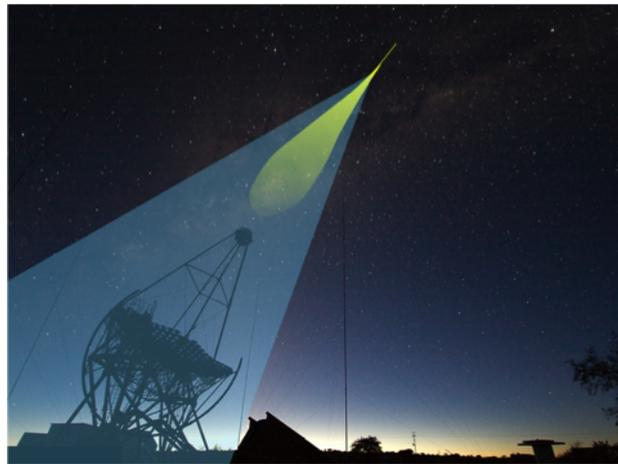
Figura 3.1: Imagen de un detector de aire Cherenkov, también conocidos como Telescopios Cherenkov de visualización atmosférica (*IACT*, por sus siglas en inglés). *Fuente Imagen:* Colaboración H.E.S.S.
