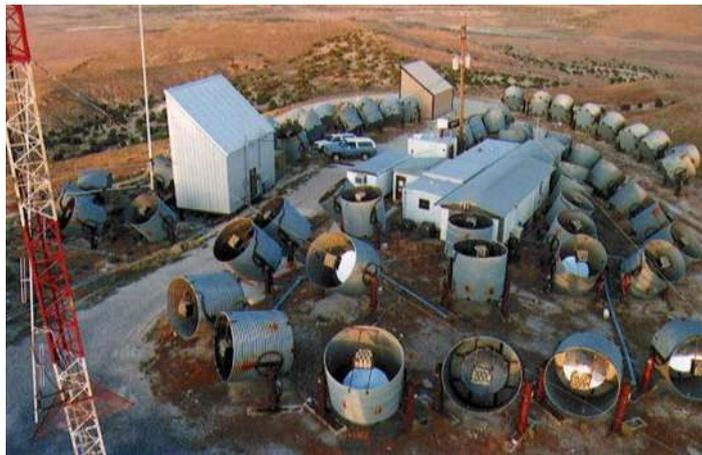
Figura 3.2: En la imagen, se puede apreciar el arreglo del observatorio *Fly's Eye* que fue construido para la obtención de datos de rayos cósmicos de Ultra Altas Energías. Los detectores que componían el observatorio se encontraban limitados a un 10% de su ciclo activo debido a que este tipo de detectores únicamente funciona en noches despejadas y sin Luna [54]. Fuente imagen: Universidad de Utah.
