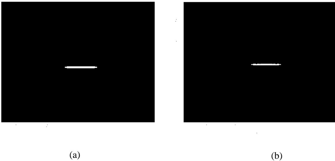
Figura 4.30 (a) Filtro para la transformada de Fourier de la superposición de las placas zonales (ver figura 4.27), (b) la transformada de Fourier con el filtro mostrado en la figura 4.30 (a) del patrón de moiré de la placa zonal.
