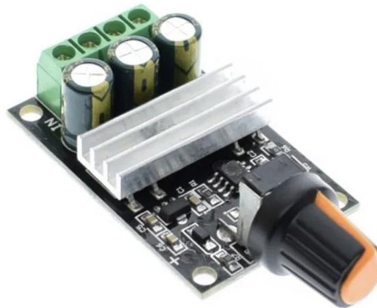
Figura 2.5: Módulo regulador de voltaje.
