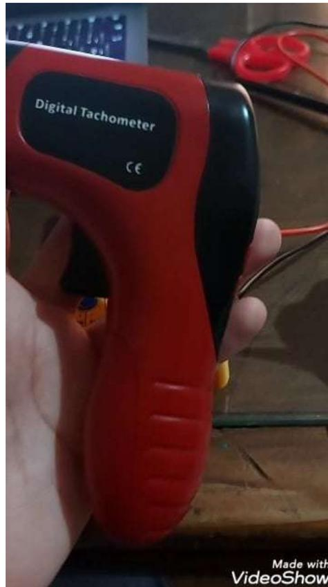
Figura 2.3: Tacómetro digital.
