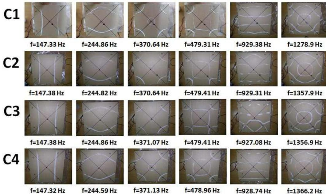
Figura 3.16: Resultados para perforaciones con  $r=0.6$  cm y a diferentes distancias radiales  $d$ ; C1 ( $d=3$  cm), C2 ( $d=6$  cm), C3 ( $d=9$  cm) y C4 ( $d=12$  cm).
