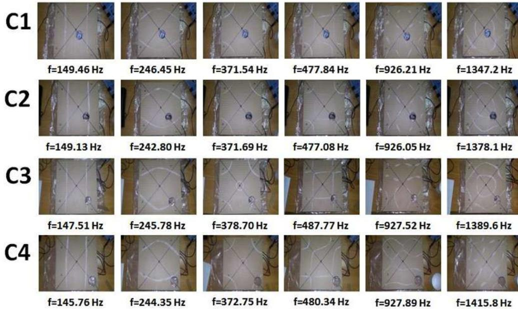
Figura 3.17: Resultados para perforaciones con  $r=2.6$  cm y a diferentes distancias radiales  $d$ ; C1 ( $d=3$  cm), C2 ( $d=6$  cm), C3 ( $d=9$  cm) y C4 ( $d=12$  cm).
