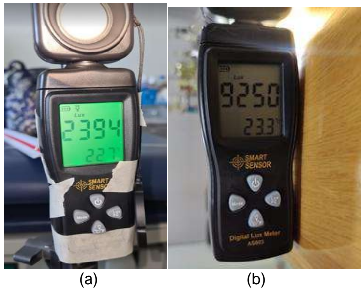
Figura 6.20. (a) intensidad con sistema antiguo (b) lectura con el nuevo sistema
