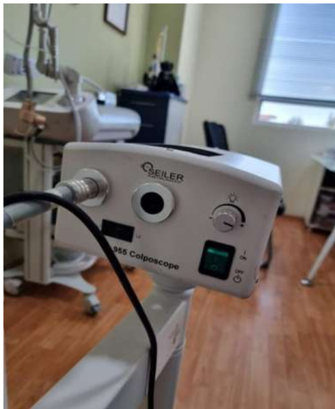
Figura 3.11. Compartimento de fuente de poder, iluminación, refrigeración, control de intensidad y conexión de la fibra óptica en la base del sistema ocular.
