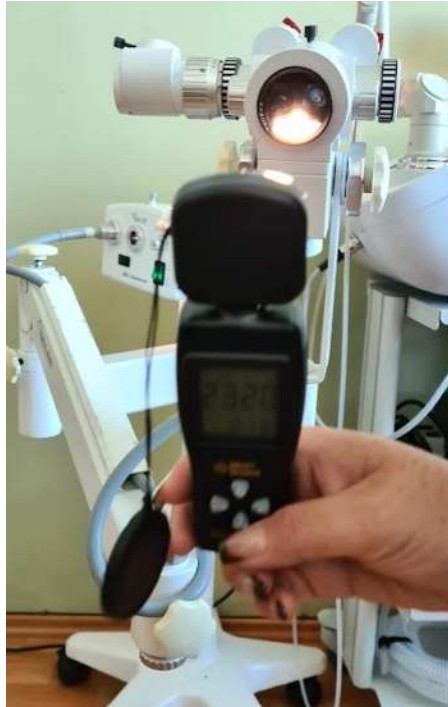
Figura 3.12 Intensidad y temperatura del haz de la bombilla de halógeno
