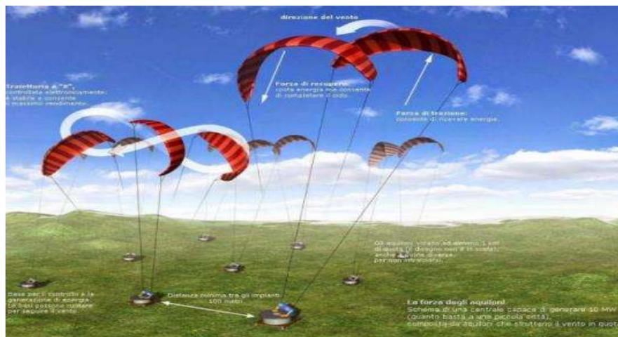
Figura 2.34 Deslizamiento en forma de 8.
