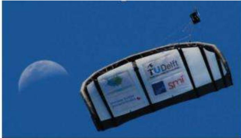
Figura 2.40 Cometa con unidad de dirección.
