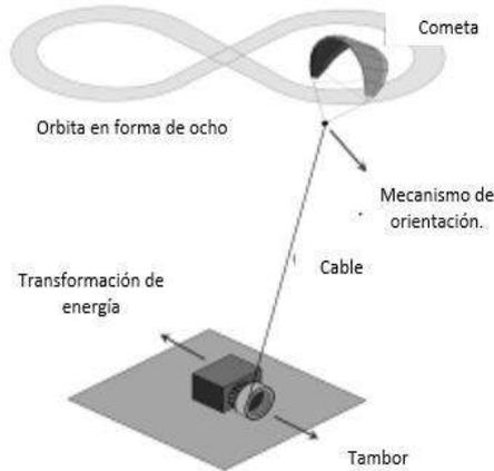
Figura 2.59 Funcionamiento básico del diseño cometa kite.
