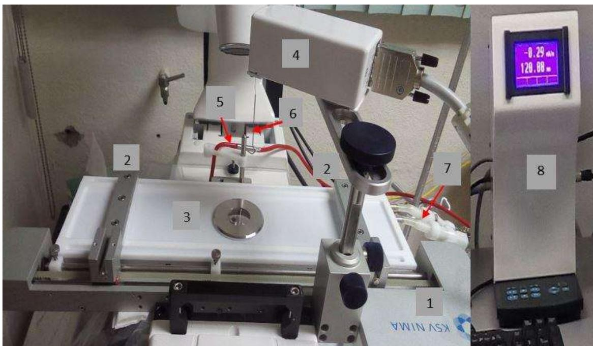
Figura 3.4. Configuración básica de una palangana de Langmuir. 1) Marco, 2) Barreras, 3) Superficie de la palangana, 4) Sensor de presión superficial, 5) Termómetro, 6) Tensiómetro, 7) Conexión a recirculador 8) Unidad de interfaz.
