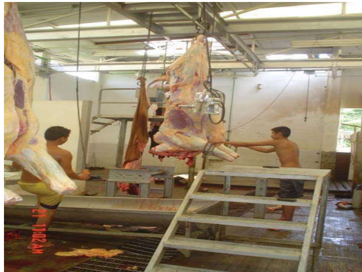
Foto 22: Eviscerado con rieles de suspensión en el municipio de Tuzantla. Es uno de los requisitos con que cumple este rastro al no realizarlo en el piso.
