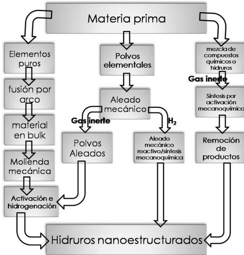
Figura 1.6.2. Esquema general de la obtención de nanohidruros por AM.
