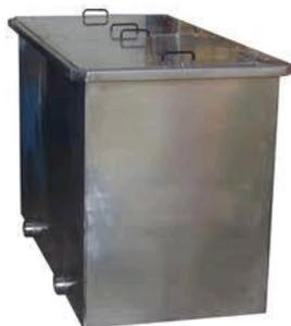
**Tanque de sedimentación** para miel de acero inoxidable de 122 x80 x60 con dos compartimentos y dos rebosaderos de tubo para filtrar la miel.
