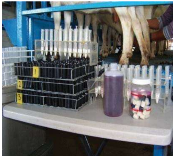
Figura 4. Equipo y materiales para la prueba de Wisconsin modificada.
