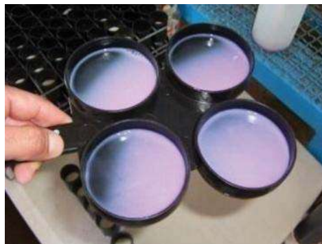
Figura 3. Aplicación del reactivo a la muestra de leche en la paleta para CMT
