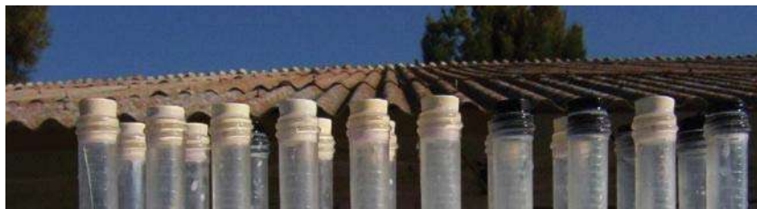
Figura 7. Colocación de tapones para la mezcla y drenado
