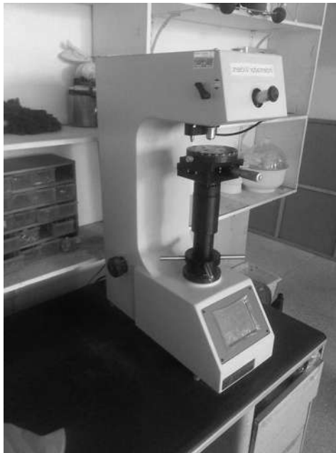
Figura 3.9 Durómetro para la medición de microdureza Vickers; escala utilizada HV 10 .
