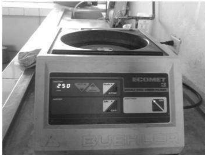
Figura 3.5 Pulidora Marca Buehler modelo Ecomet 3 utilizada para el pulido de las muestras con paño de nylon y pasta de diamante.
