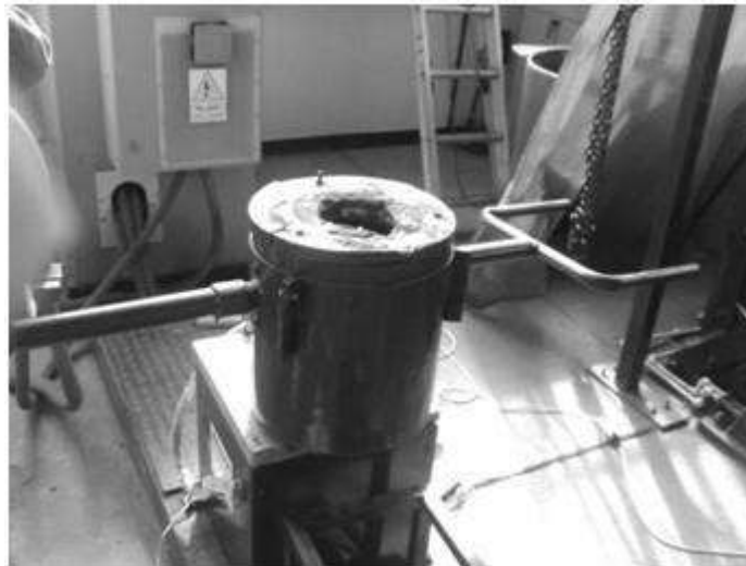
Figura 3.1 Horno de inducción con capacidad de 30 kg, utilizado para la fusión de las aleaciones de hierro.
