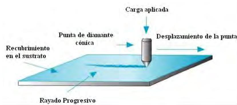
Figura 23. Esquema de una prueba de Nano-rayado.
