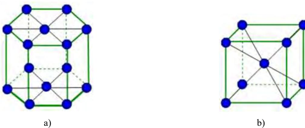
Figura 4. Estructuras cristalinas presentes en el Ti: (a) fase  $\alpha$  de baja temperatura y (b) fase  $\beta$  de alta temperatura indicando los valores de los parámetros de red y los índices de Miller de los planos de mayor densidad para cada estructura<sup>[10, 27]</sup>.
