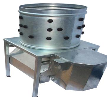
Figura 15. Máquina desplumadora.
