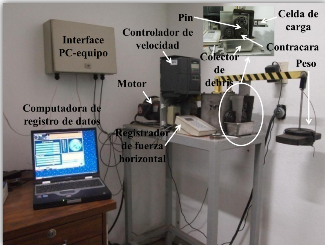
Figura 19. Componentes de la máquina de desgaste “Probeta sobre anillo rotatorio”.
