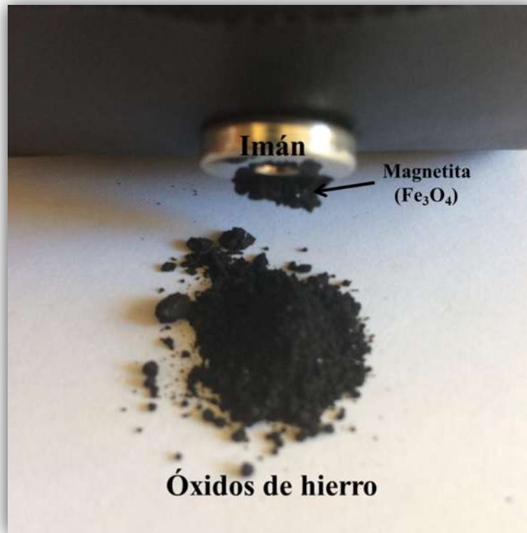
Figura 70. Imagen que muestra la tonalidad negruzca y características magnéticas de los fragmentos de desgaste.
