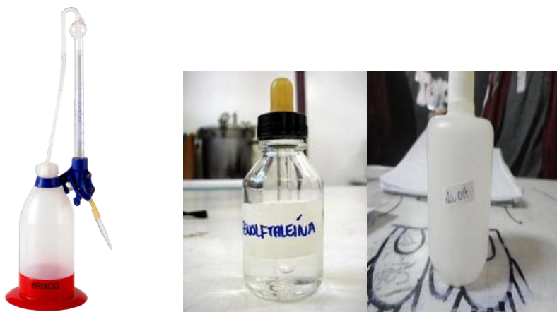
Figura 4. Acidímetro, Solución Alcohólica de fenolftaleína al 1%, Hidróxido de Sodio (NaOH) 0,1 N.
