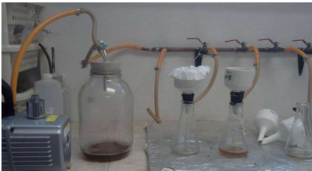
Figura 9. Embudos acoplados a matraces en un sistema de vacío por bomba eléctrica (proceso de filtrado).
