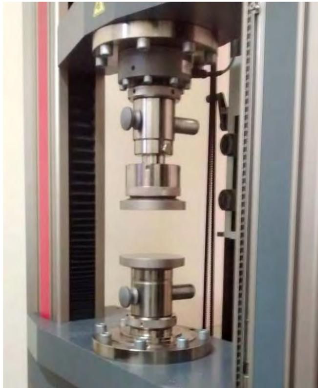
**Figura 3.10** Máquina universal para ensayos mecánicos, *IIMM-UMSNH*.
