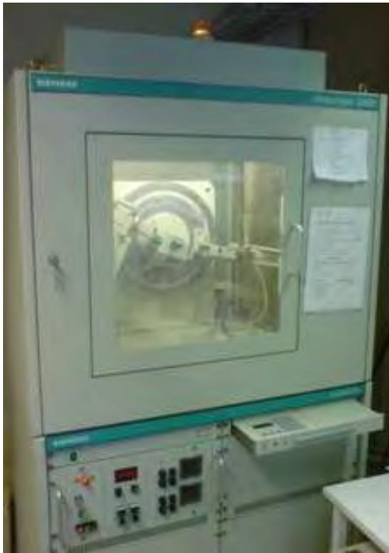
**Figura 3.7** Difractómetro Siemens D5000, IIM – UNAM.
