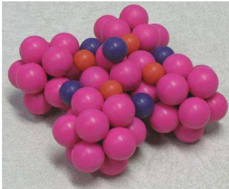
**Figura 2.16** Porción de la celda de cúmulos con estructura  $\langle 12,10,9 \rangle_{fcc}$  [3].
