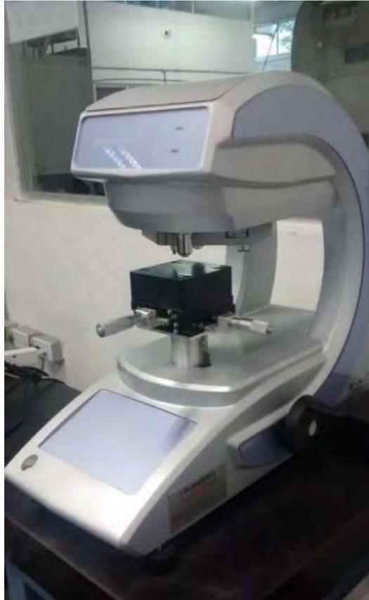
**Figura 3.9** Microdurómetro *HV* Shimadzu HVM-G, IIM – UNAM.
