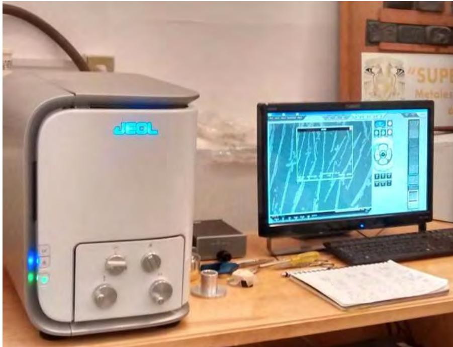
**Figura 3.8** MEB con detector EDS JEOL D600, IIM – UNAM.
