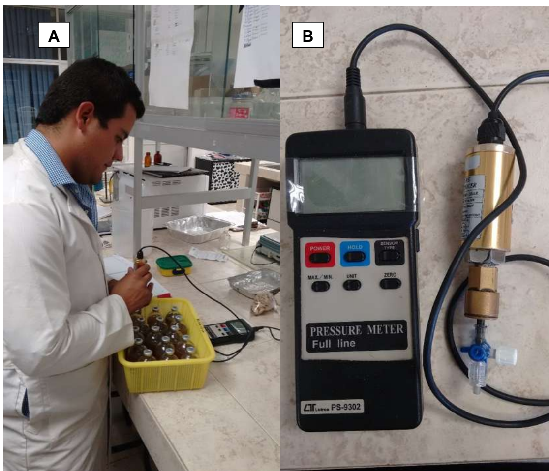
FIGURA. 8. A) Medición de la acumulación de gas; B) transductor (Fotos del autor).
