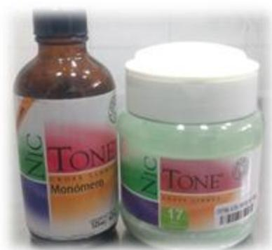
**Figura 17.** Monómero (Metil metacrilato) líquido y un polímero de acrílico (poli metilmetacrilato) polvo, en presentación termocurable. Fuente: (MDC Dental, 2011).
