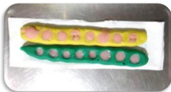
**Figura 19.** Barras de plastilina con orificios circulares rellenos de PMMA, utilizados como molde para la fabricación de los botones de acrílico para este estudio.
