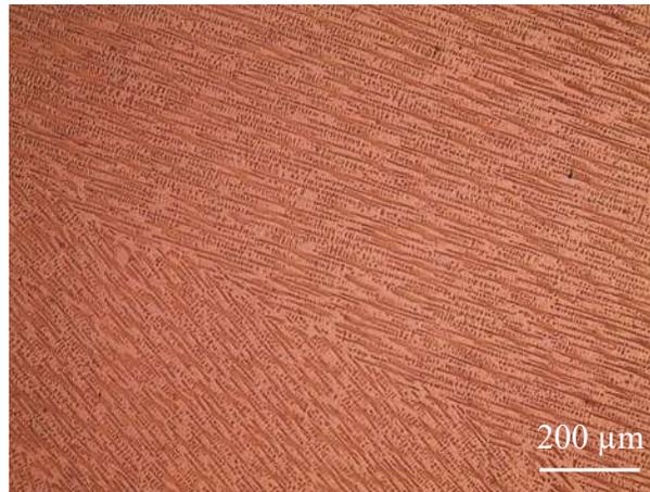
**Figura 4. 13** Microestructura del centro del cordón de soldadura de la unión AL6XN-AL6XN.
