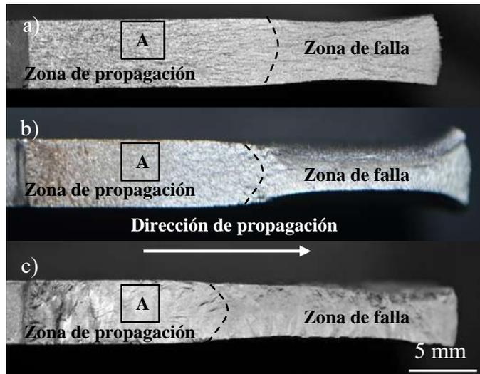
**Figura 4. 43** Fractografías de las muestras del ensayo de crecimiento de grieta para los materiales base; a) IN718 endurecido por precipitación, b) AL6XN como se recibe y c) cordón de soldadura.
