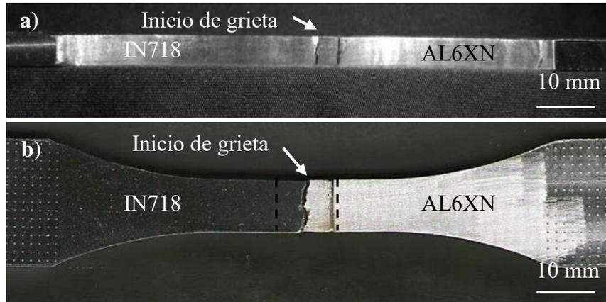
**Figura 4. 38** Probeta de resistencia a la fatiga de la unión IN718-AL6XN; a) vista lateral y b) vista superior,  $R=-1$ , esfuerzo máximo de 320 MPa.
